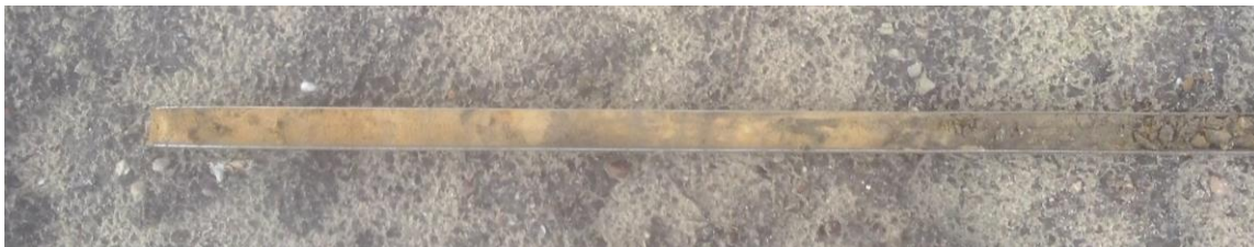
Figuur 16: Foto van de laag geel zand met daarin brokken humusrijk zand zoals deze in de boringen 3, 4 en 6 tot en met 10 is aangetroffen.
