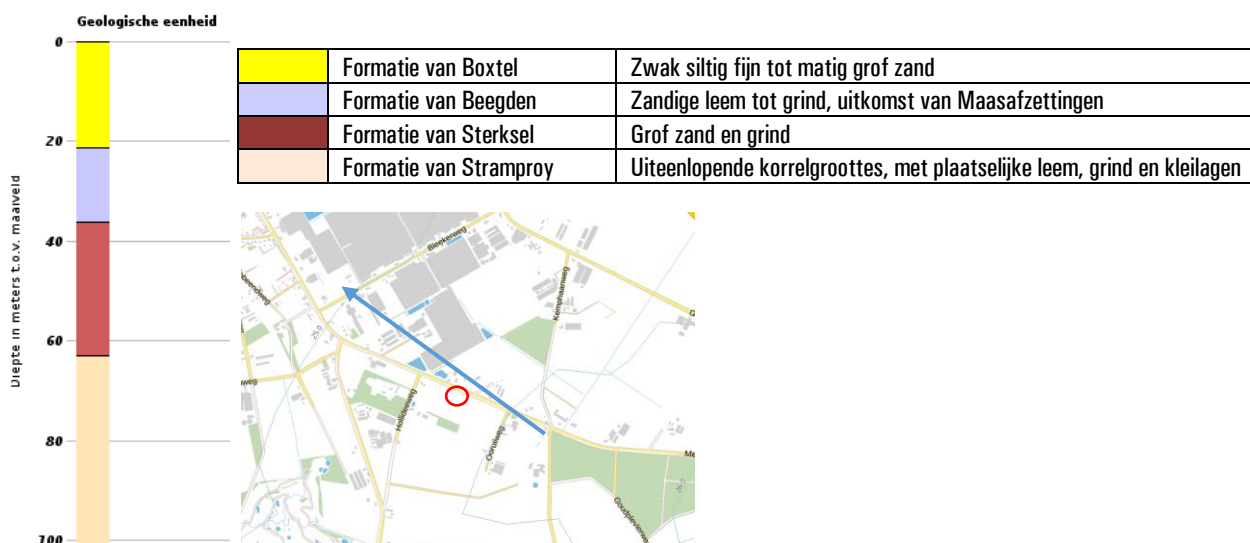
Figuur A: opbouw ondergrond.
