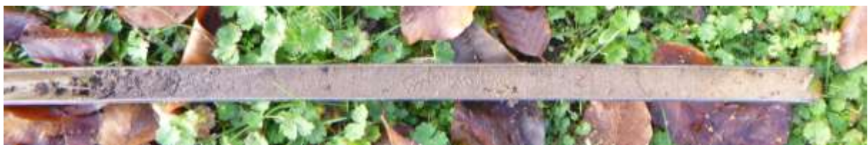
Figuur 21: Foto van het matig humeuze zand zoals dit in boring 3 onder de bouwvoor (geheel links), is aangetroffen.
