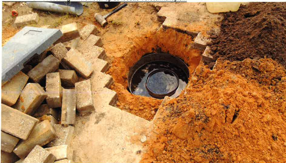
foto: veldwerk dubbelringinfiltrometer op de locatie Vorstermansplein
